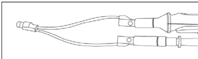
**REMARQUE :** L'adaptateur BNC ne rend pas le Pokit Pro compatible avec les fils de l'oscilloscope. Les fils de l'oscilloscope contiennent une résistance en série qui interfère avec les circuits de mesure de tension à l'intérieur du Pokit Pro.
