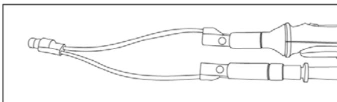
**HINWEIS:** Der BNC-Adapter macht das Pokit Pro nicht kompatibel mit Oszilloskopkabeln. Oszilloskopkabel enthalten einen Serienwiderstand, der die Spannungsmessschaltung im Pokit Pro stört.
