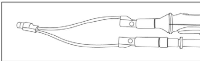
注記：BNCアダプタは、PokitProとオシロスコープのリードの互換性を可能にする補助具ではありません。オシロスコープのリード線には、PokitPro内の電圧測定回路に干渉する直列抵抗が含まれています。
